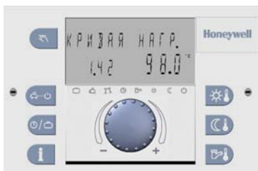
Задана кривая 1.42, т.о. температура воды будет 98 °C при уличной температуре -35 °C
